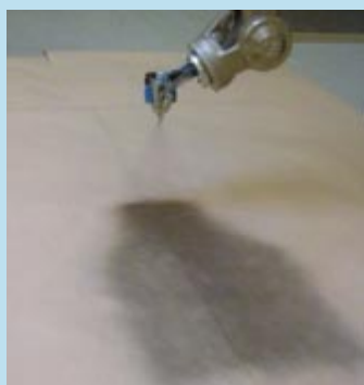
Bei gegebener Materialmenge und entsprechender Zerstäuberluft kann der Roboter über die Änderung der Hornluft die Strahlbreite ändern
